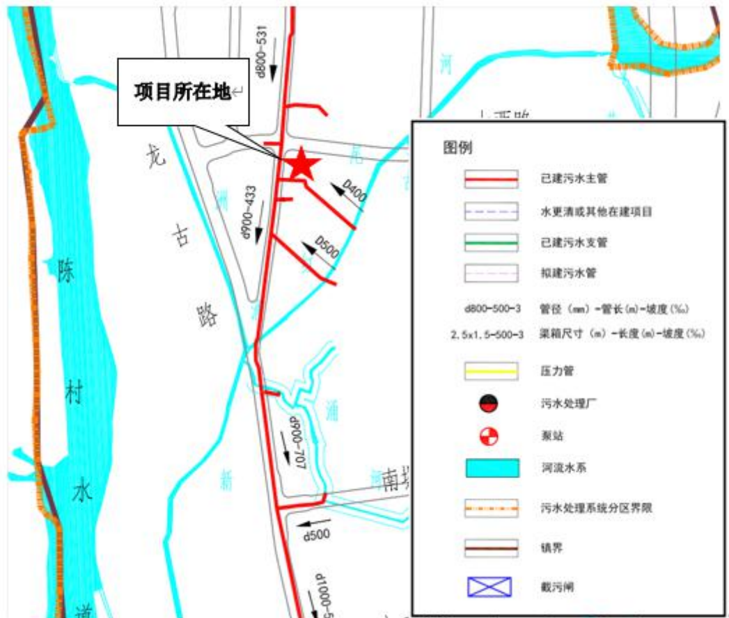
图 4.1-1 前锋净水厂于本项目地铺设的污水管网图
